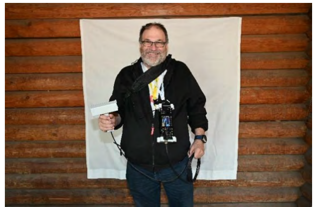
Abbildung 2 : «Interference-Buster» HB9RMW mit HF-Sonde (Feritstab), mCHF Empfänger und Batterie im Rucksack
