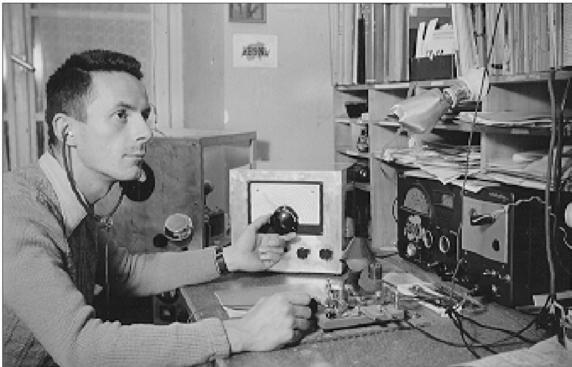
HB9NL vor PA-Rack mit 813, VFO, Vibroplex, S-40
