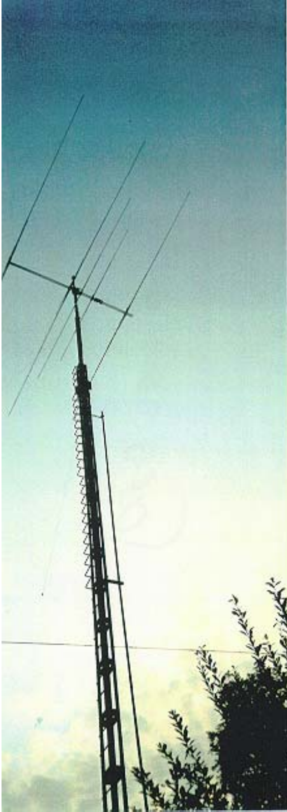
Yagi P6C auf 3 Elemente verkürzt und mit Shuntspeisung aus 20mm Aluminium-Rohr ausgerüstet.
