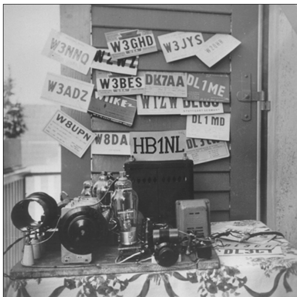
PA-Kreis, T50, 8005, HV-Trafo, Heiztrafo, Kristalexiter
