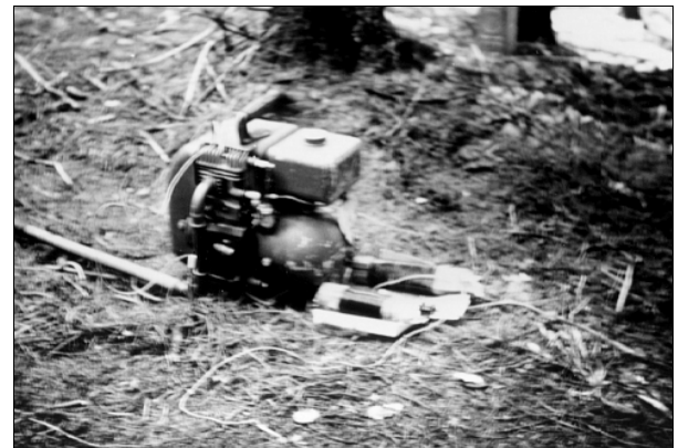
Benzingenerator mit "Knebelfilter"
