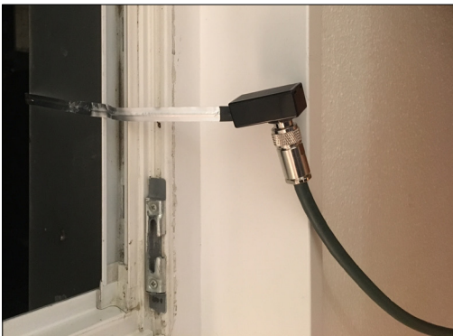
Koax-Fensterdurchführung (max. 100 W)
