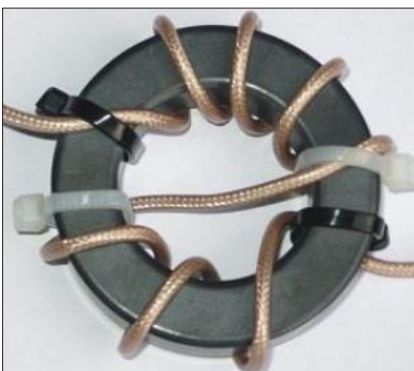
Balun für Steuerleitung des ATU
